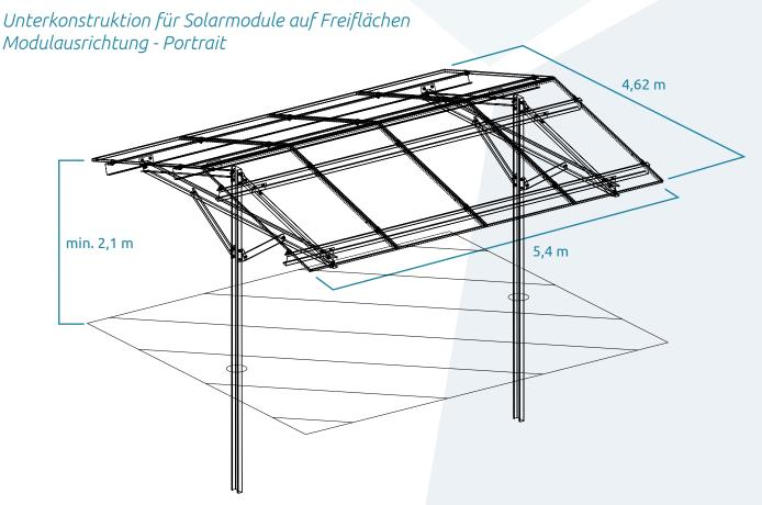
Tiefe der Rammprofile im Boden wird individuell je nach Qualität des Bodens, des Aufstellungsortes sowie der Wind- und Schneeverhältnisse festgelegt, Ausgangswert 1,6 m
