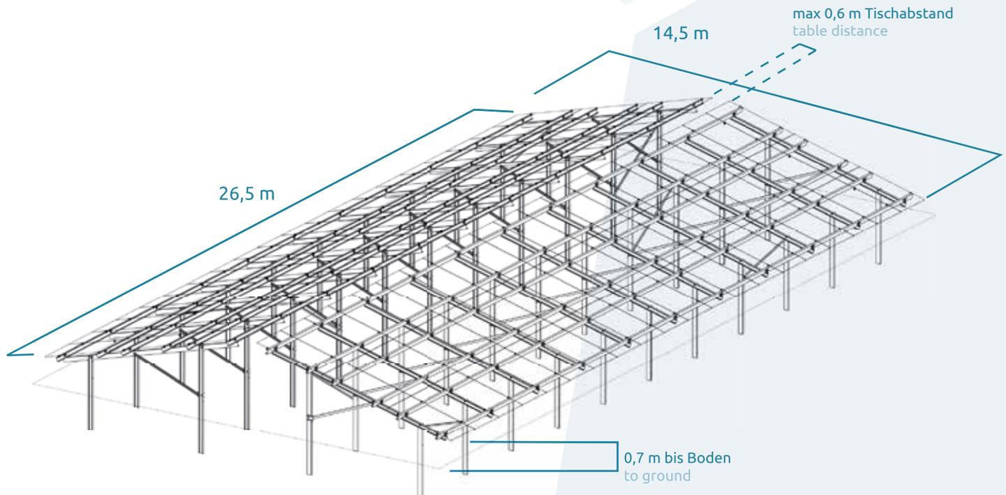
Tiefe der Rammprofile im Boden wird individuell je nach Qualität des Bodens, des Aufstellungsortes sowie der Wind- und Schneeverhältnisse festgelegt, Ausgangswert 1,5 m
